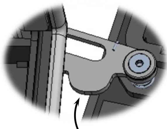
Um die Tür beim Reinigen offen zu halten, muss dieser Hebel nach hinten geschwenkt werden.
