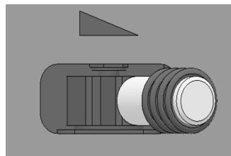
Die „optimale“ Luftschieberstellung hängt vom Schornsteinzug ab und muss daher zunächst erprobt werden. Das bedeutet, dass Sie, während der ersten Heizphasen das Brennverhalten beobachten und die Luftschieberstellung entsprechend anpassen.
